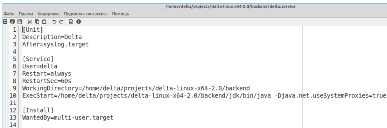
Рисунок 156 – Параметры сервиса в файле delta.service
